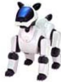
図1 自律型ロボット犬 AIBO
